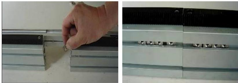
Рисунок 1. С каждой стороны вставьте по 8 квадратных гаек
