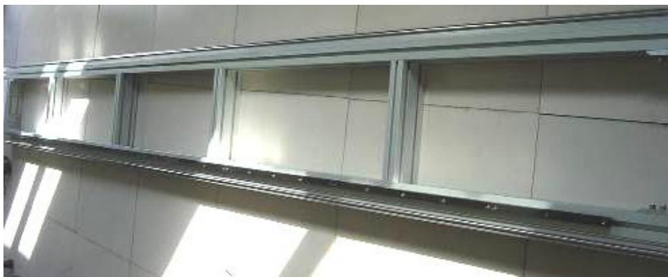
Рисунок 4. Направляющая ОСИ Х в сборе
