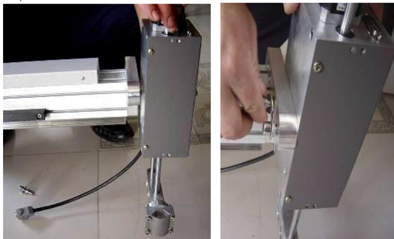
Рисунок 1. Совместите отверстия и закрутите в них 2 болта
