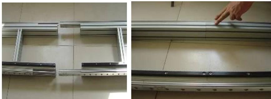
Надежно прикрепите секцию с зубчатой рейкой к направляющей
