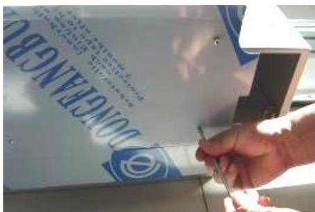
Рисунок 1. Отсоединение защитной стенки
