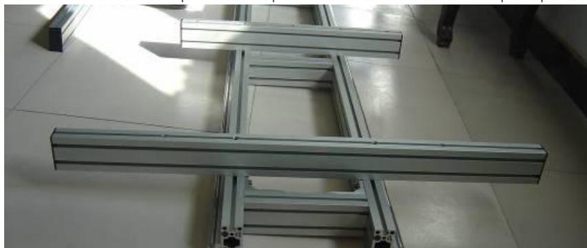
Рисунок 8. Закрепите 2 блока на расстоянии 200 мм от края рамы
