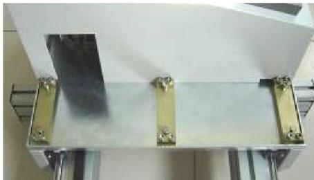
Рисунок 2. Съём кожуха, закрывающего балку
