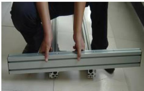
Повторите последний шаг, присоедините другой подкладной поперечный блок, так чтобы оба эти блока были закреплены на расстоянии 200 мм от обоих краёв рамы.
