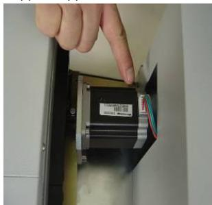
Рисунок 5. Вставьте разъём в приводной двигатель
