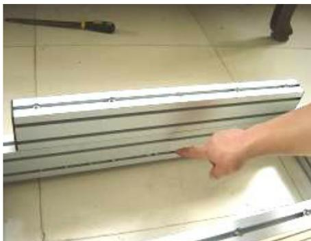
Рисунок 6. Присоединение подкладных продольных блоков к месту стыка направляющих
