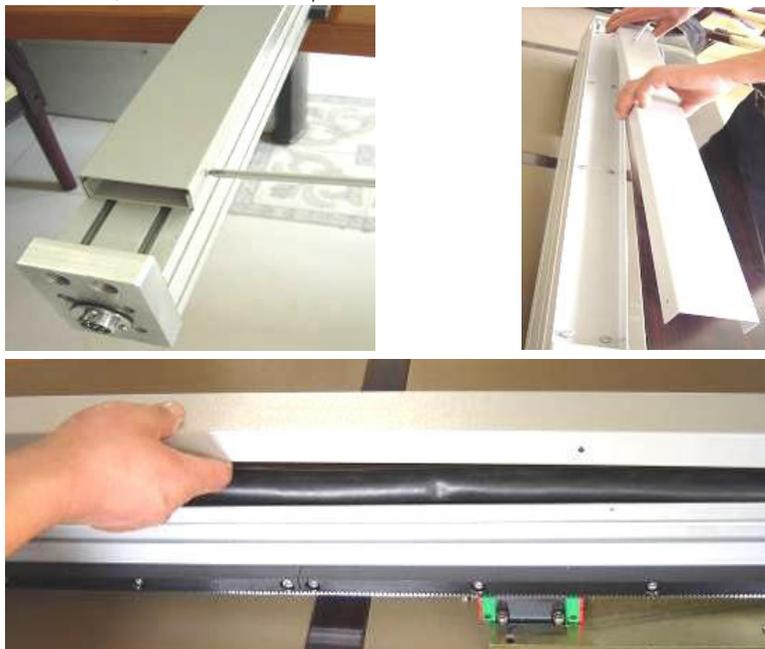
Рисунок 4. Укладка кабеля плазменного резака
