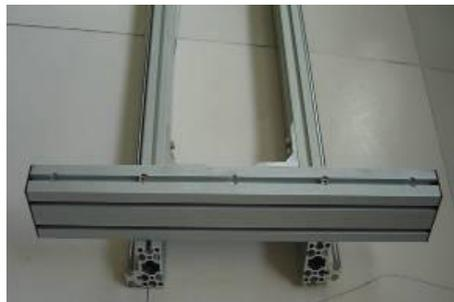
Повторите последний шаг, присоедините другой подкладной поперечный блок, так чтобы оба эти блока были закреплены на расстоянии 1000 мм от обоих краёв рамы.
