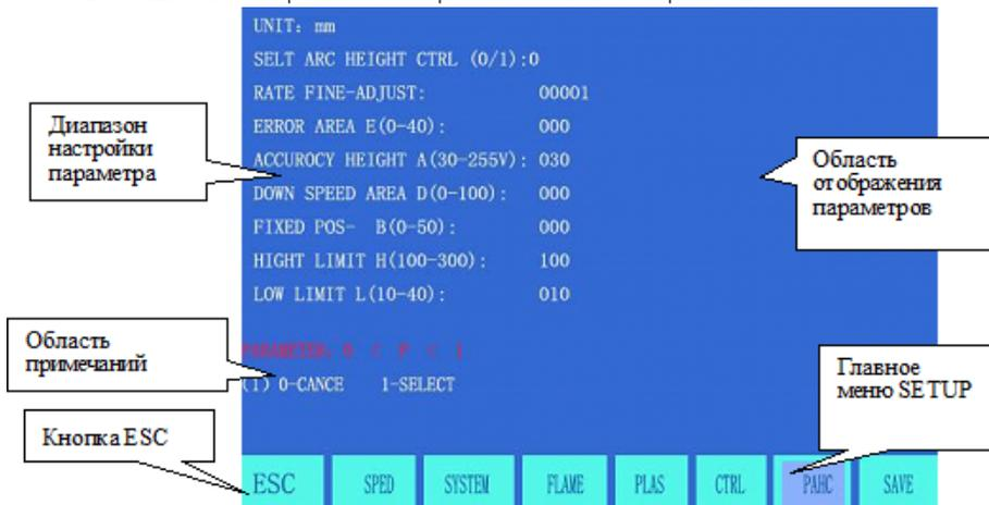
Рисунок. 12.7. Функция регулировки высоты
