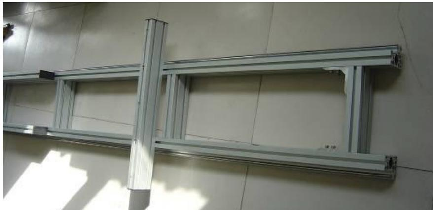
Рисунок 7. Закрепите 2 блока на расстоянии 1000 мм от края рамы
